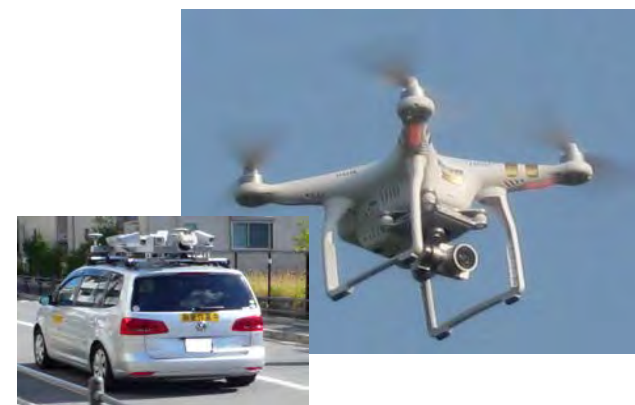
レーザ測量等に加え、 ドローンによる3次元測量も可能に
